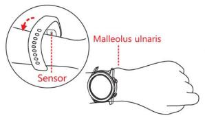
Legen Sie die Uhr so um Ihr Handgelenk, dass die Rückseite mit dem Herzfrequenzsensor eng an der Handoberfläche anliegt, siehe Abb.
